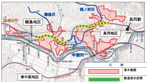
平成26年6月梅雨前線豪雨による浸水被害状況
