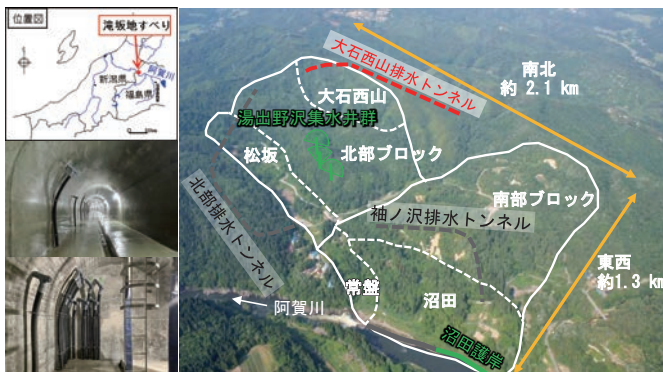
滝坂地すべり全景と完成した大石西山排水トンネル
