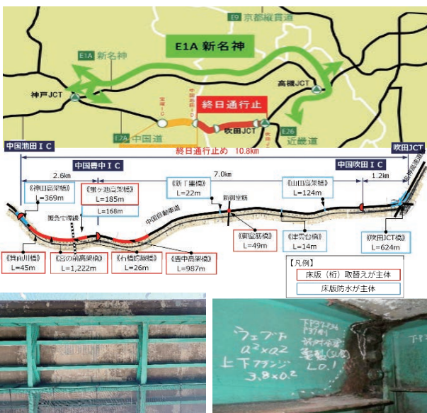
事業位置図及び対象橋梁とその劣化状況
